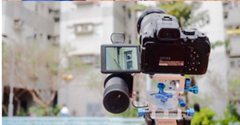
人工智能遙距甲烷檢測儀配合自動轉向雲台，令技術員更方便使用
