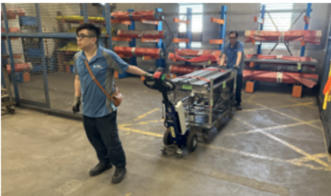
倉務員使用自動升降管材運輸車運送管材
