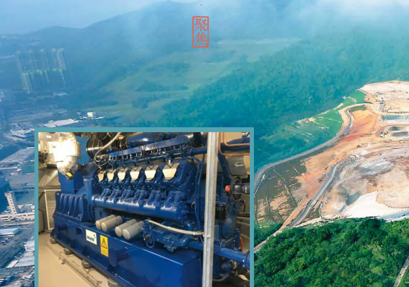
熱電聯供系統以沼氣發電, 提供電力及熱能予醫院部分設施, 轉廢為能
