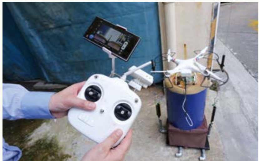
在飛行器前端有一個攝像頭,在飛行過程中拍攝到的畫面,可以被實時傳送到操控手柄上的手機畫面中
