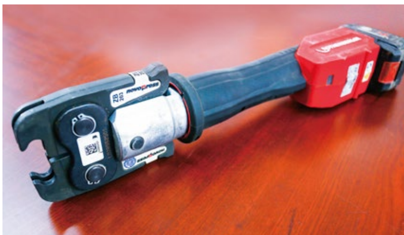
卡壓設備、管件在立管維修當中的應用
