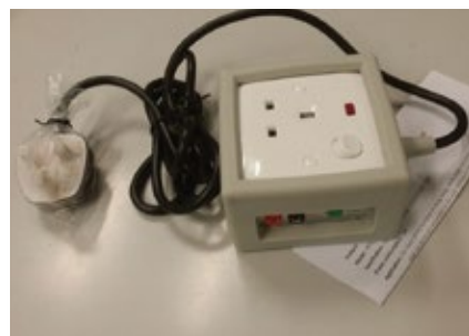
智能電插座: 鑽孔過程中如不慎鑽到牆內之金屬管道或電線, 此裝置會實時截斷電鑽之電源而令電鑽停止轉動, 防止對牆內設施造成破壞
