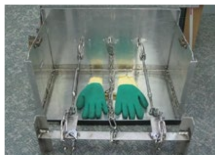
安全箱: 在原来的煙窗開孔位置更換新煙窗, 無需於外牆搭建工作台, 安全、快捷且可節省成本
