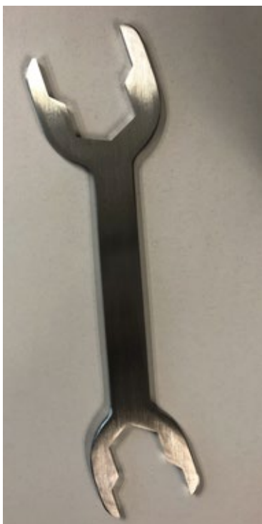
四合一多功能板手: 適合用於煮食爐接駁氣位、熱水爐冷熱水位及煤氣接駁氣位、煤氣錶接駁位及煤氣錶調壓器半硬管接駁位, 可更快捷收緊接駁位而不破壞配件
