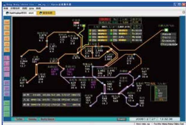
SCADA系統-管網圖形監控調度
