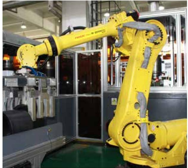
自動化生產設備配以機械人精準操控，令PE管件生產效率大幅提升
