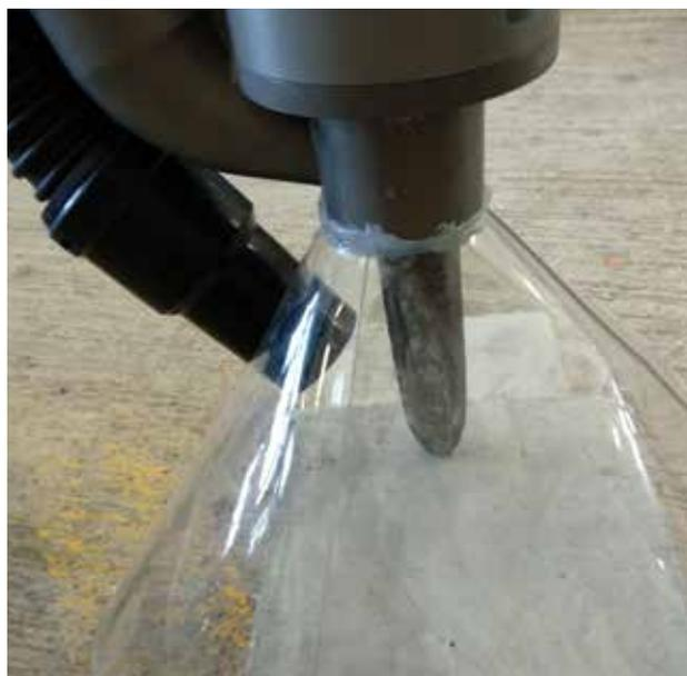
吸管直接安裝在吸盤，與炮尖距離近，能更加有效地吸走灰塵
