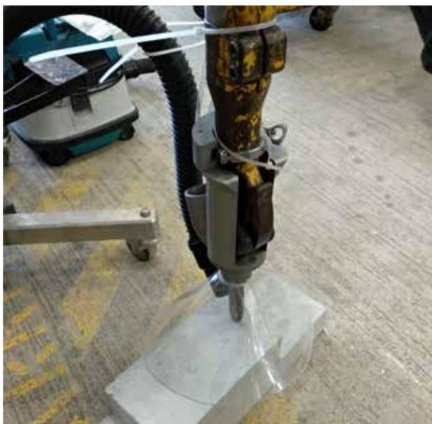
圖中銀色圓筒便為鋁合金配件主體，底部的透明漏斗是PVC吸盤
