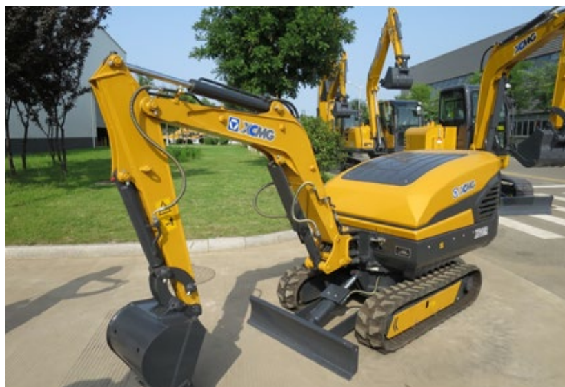
「小天鵝」遙控挖掘機有助增強開挖的準確性
