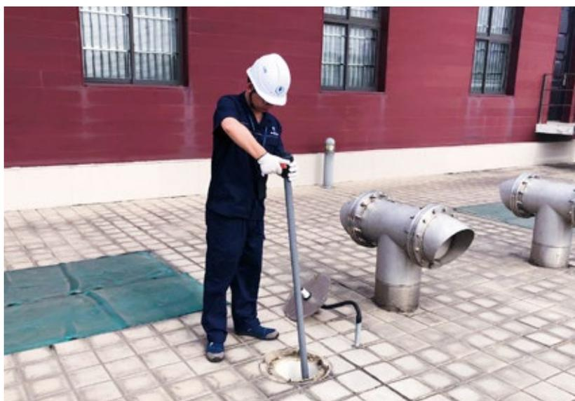
工作人員利用取樣桿透過液位儀洞口取樣品，取樣桿在設計上長於炭濾池深度，便於調整，按需取樣。
