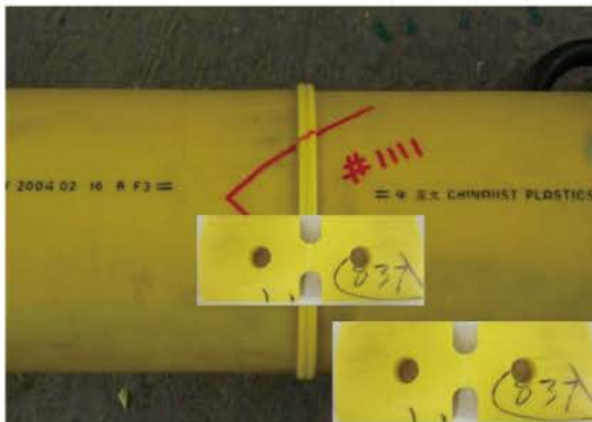
聚乙烯對熔接口及拉伸啞鈴型樣品
