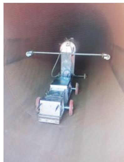
X射線管道爬行器彎管通行裝置
