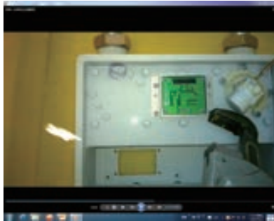
浸水法洩漏檢查
