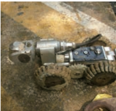
履帶車攜帶攝像頭檢視管道內狀況
