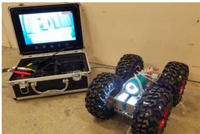
管道檢測車可在管道內靈活操作，有效提升管道檢測效率
