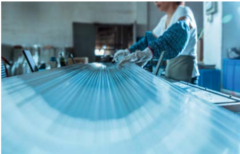
玻璃廠以天然氣作能源進行加工工序，工作人員正在處理玻璃管半製成品
