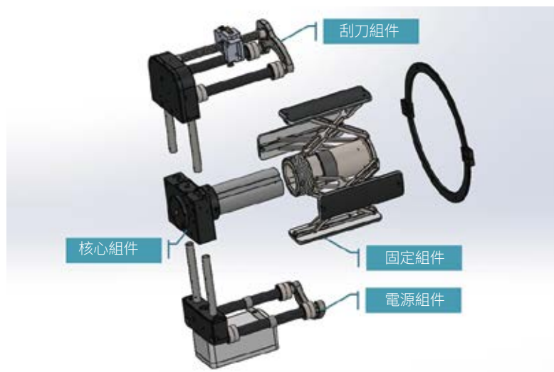
電動刮刀的構成部分與組裝
